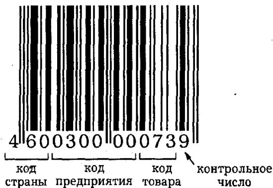
Рис. 11.1. Структура штрихового кода EAN-13
